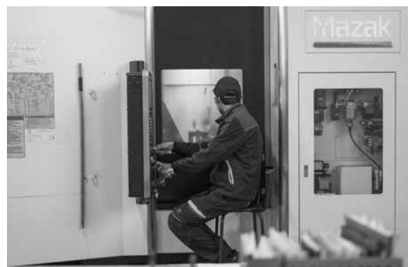
Механический цех завода укомплектован металлообрабатывающими станками фирмы Mazak. Они рассчитаны на круглосуточный режим работы, по регламенту на обслуживание отводится 5% времени. Каждый станок способен обрабатывать детали с точностью до сотых долей миллиметра. Чтобы овладеть подобным станком, необходима способность мыслить пространственно, представлять процессы в трехмерном изображении. Основной навык, необходимый для приема на работу оператора – умение читать чертежи, разбираться в характеристиках качества металла.
