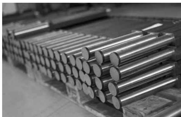
На первом этапе работы металлопрокат режут на полуавтоматической пиле. Получаются грубые заготовки квадратной и круглой формы. Далее из них вытачивают составные части механизма стрелочного переводчика. Трудные части этих деталей укрепляют закаливанием на участке термообработки. Это делает станок, который выполнил для завода по специальному заказу институт токов высокой частоты из Санкт-Петербурга. Станок сконструирован под определенную задачу: специальный индуктор нагревается до температуры 900 градусов, закаляя небольшие критически важные участки деталей. В итоге в этих местах твердость металла повышается от 28 до 60 единиц, что обеспечивает долговечность основных узлов.
