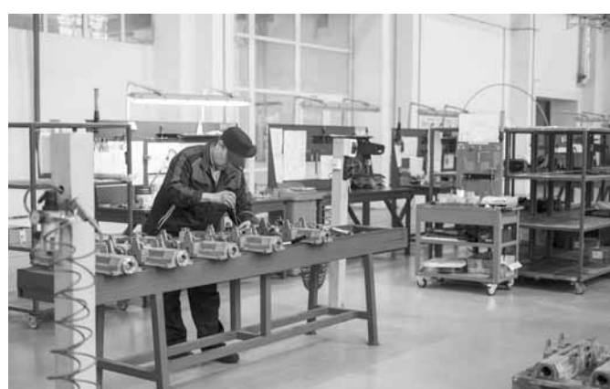
После ОТК детали попадают на склад, откуда комплектами перемещаются в сборочный цех. Здесь работа строится по принципу пузоловой сборки: сначала собираются отдельные технические узлы, в финале – общая сборка. Такая организация считается эффективней раздельной последовательной сборки. Конечный продукт по степени влагозащитности сравним со смартфоном. Внутренности обрабатываются антикоррозийной смазкой, сохраняющей эффективность 20 лет непрерывной эксплуатации. На верхней части корпуса расположен счетчик срабатываний, он состоит из шести цифр. Финальное тестирование, замер усилия толкателя стрелки и автоматического отключения электропитания на случай аварии – и очередной стрелочный переводчик готов к работе на железной дороге.
