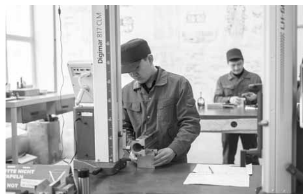
ОТК – совесть производства. Здесь изделия проходят 3D-контроль. Лаборатория оснащена специальными столами, чья поверхность выведена в полную горизонталь, и инструментами, позволяющими обнаружить микронные отклонения от эталона. Проверке деталь подвергается на каждом переделе: перпендикулярность, соосность, чистота обработки металла. Сердце производства – инструментальный цех. Металлообработка требует особого качества инструментов. Прежде чем дать инструменту допуск к работе, эксперты проверяют его по ряду показателей. Использование инструмента с отклонениями от нужных параметров может повлечь вибрацию такой силы, которая разрушит станок.
