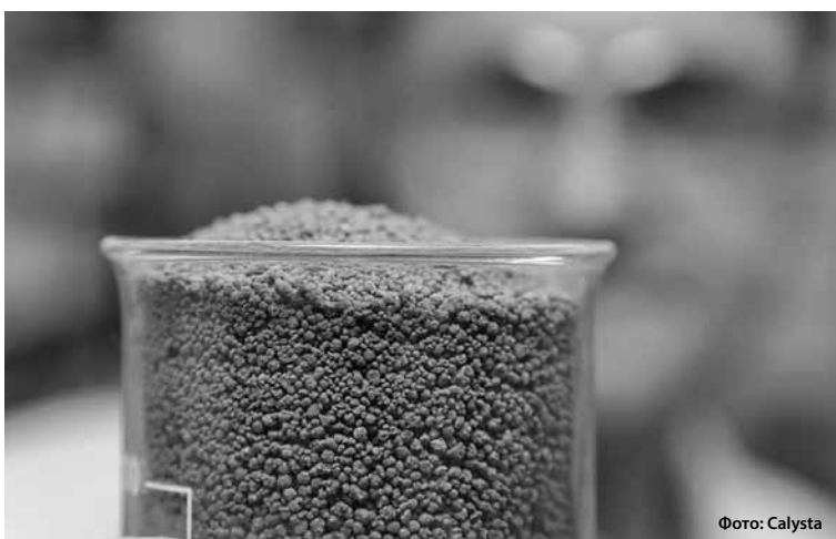
Calysta использует бактерии для синтеза белка из природного газа и последующего его использования в качестве альтернативного корма для рыб. В процессе производства белку придает форму пеллет либо порошка.
