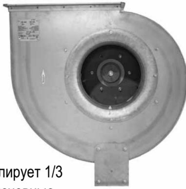
Мощные промышленные вентиляторы из-за внешнего сходства с колесом так и называют. Официальное название – рабочее колесо с обратно загнутыми лопастями высокоэффективное. Максимальный диаметр производимых на АВЗ вентиляторов-колес – 125 см, вес одной лопасти достигает 4 кг.
